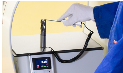
Messung von Restmagnetismus eines Fräasers in der Null-Gauss-Kammer. Der entmagnetisierte Fräser weist einen Restmagnetismus von 0,1 \text{ A/cm} auf
