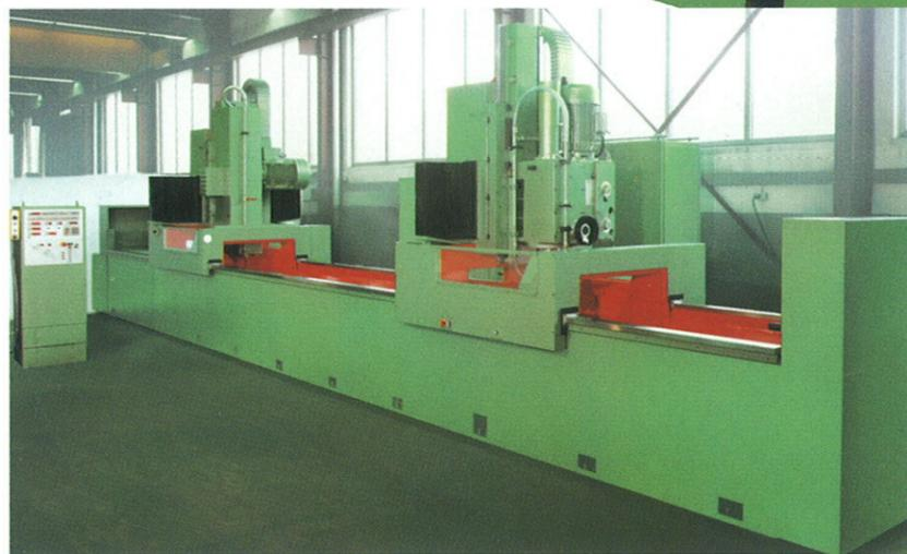
6 Kombinierte Produktionsmaschine mit Fräswagen und Umfangsschleifwagen. CNC gesteuert, 6 Achsen
