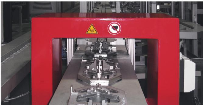
Die Spulen entmagnetisieren selbst bei sehr hohem Füllgrad zuverlässig
