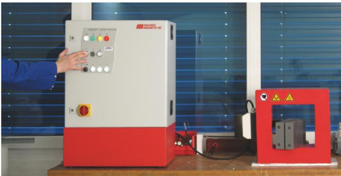
Die Bedienung erfolgt in sicherem Abstand zur Spule, um eine unzulässige Feldexposition zu vermeiden
