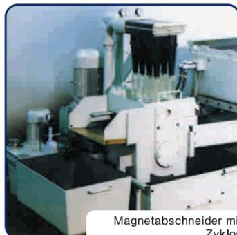
Magnetabscheider mit Zyklon
