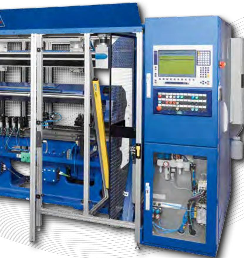
Richtmaschine mit Ladeportal, Aussortierstation und zusätzlicher, über ein Lichtgitter abgesicherter manueller Belademöglichkeit.
