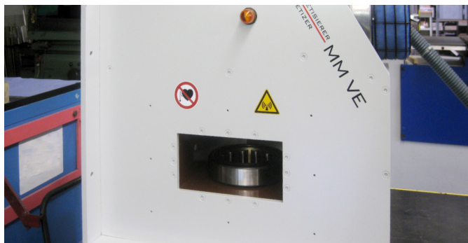
Entmagnetisierung von montierten Wälzlagern mit Pulstechnologie und hoher Feldstärke
