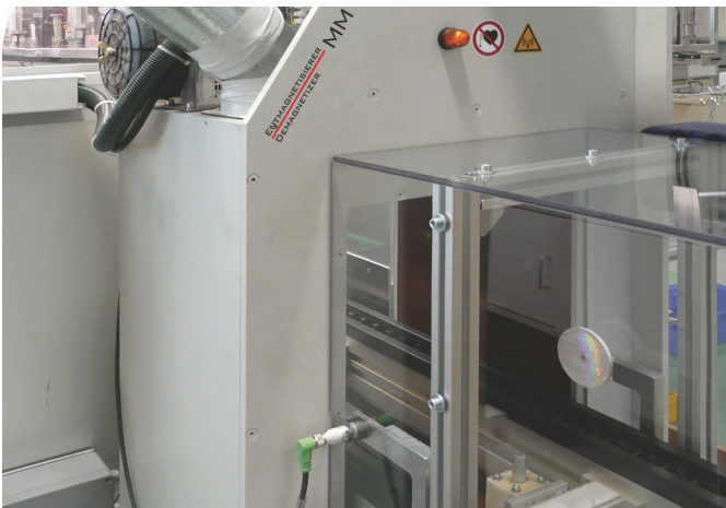
VE mit integrierter Lichtschranke zur Pulsauslösung. Die Anlage arbeitet dadurch autonom
