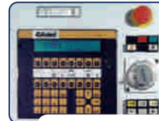
Steuerpult mit Bedienfeld für Maschinen NC-Steuerung
