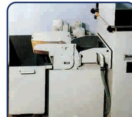
Magnetabschneider zur Kühlmittelreinigung
